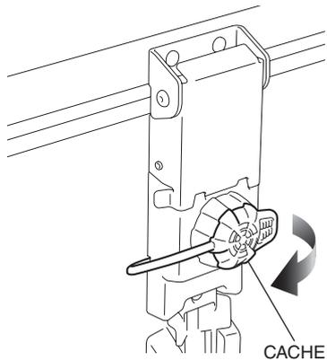
2. Insérez la clé et tournez-la dans le sens des aiguilles d'une montre pour déverrouiller la serrure.
