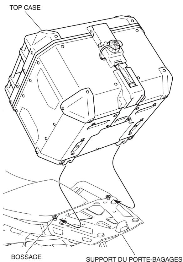
3. Installez le top case en alignant le trou du top case sur le crochet.
