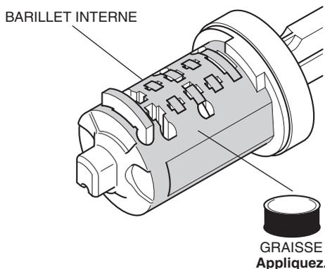
21. Montez le barillet interne en faisant glisser le contrepois de butée le long du guide d'insertion tout en faisant tourner.
