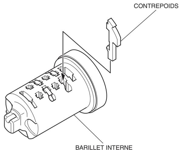
9. Répétez les étapes 4 à 8 en insérant différents contrepoids aux emplacements marqués jusqu'à ce qu'aucun contrepoids ne soit saillant.
